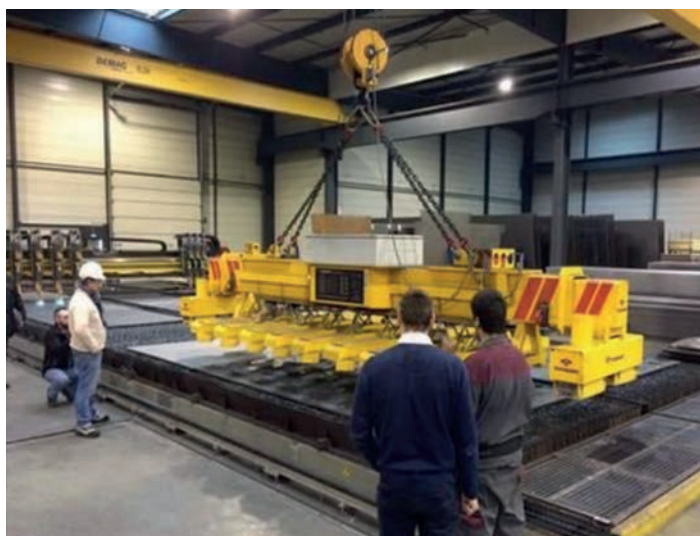
Permanent-elektromagnetische COMBI-serie voor het beladen/ontladen van afkortmachines in een enkele handeling (plasma, laser...)
